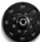
Plateau de ponçage Avec fixation auto-agrippante, Ø 150 mm avec trou d'aspiration M 14. Trou d'axe pour abrasifs FEIN et abrasifs d'autres marques.
