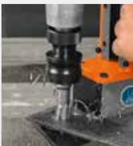
Perçage par carottage
