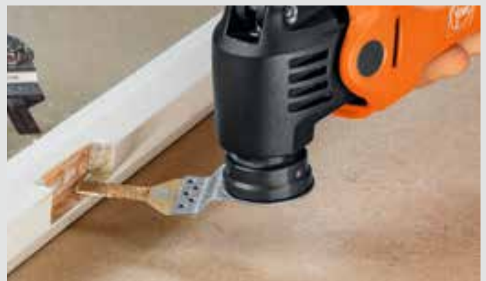
Uitsparingen zuiver en nauwkeurig uitvijlen.
