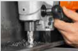
Perçage par carottage
