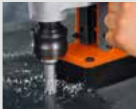
Perçage par carottage
