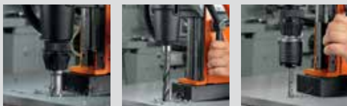
Perçage par carottage
