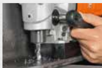
Foratura con punte elicoidali
