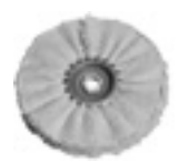
Roue à lamelles en feutre Pour le polissage et le prépolissage de l'acier inoxydable. Les lamelles empêchent que le feutre ne « brûle » et permettent ainsi un polissage sans formation de bandes. Utiliser uniquement avec de la pâte à polir (Prépolissage = Pâte de prépolissage, Polissage brillant = Pâte de polissage).
