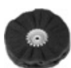
Disques fibres plissé, largeur env. 30 mm, alésage 14 mm, pour des travaux d'ébarbage léger, désoxydation, travaux de meulage léger, travaux de décoration
