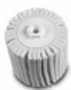
Roue à lamelles en feutre Pour le polissage et le prépolissage de l'acier inoxydable. Les lamelles empêchent que le feutre ne « brûle » et permettent ainsi un polissage sans formation de bandes. Utiliser uniquement avec de la pâte à polir (Prépolissage = Pâte de prépolissage, Polissage brillant = Pâte de polissage).
