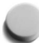
Polírozóhab Lakkozott felületek polírozására. Különböző keménységi fokok: puha az újonnan lakkozott felülethez, közepesen kemény az időjárási behatások miatt kissé megkopott felülethez és viaszrétegekhez, kemény az erősen megkopott felületekhez. Tépőzáras rögzítés, magassága 40 mm.
