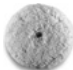
Süvegformájú báránygyapjú Kb. 230 mm átmérő Ø 170 mm csiszolótányérhoz, 6 38 06 187 01 0 M14 tépőzárral. Ajánlott munkafordulatszám 500-1200 ford/perc, TOPWOOL minőség, Frisbee polírozó tárcsa. Mosható báránygyapjú/műszál keverék
