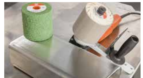
Weitere Bearbeitung der Oberfläche mit K400, K800 und K1400 Vorbereitung zum Polieren
