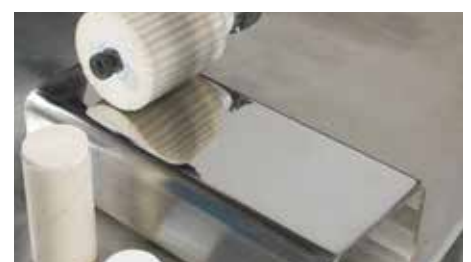
Nach der Bearbeitung mit der Abglänpaste optimaler Spiegelglanz auf Edelstahlfächen
