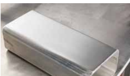
Oberfläche bis K1400 vorgeschliffen, alle Kratzer müssen beseitigt sein
