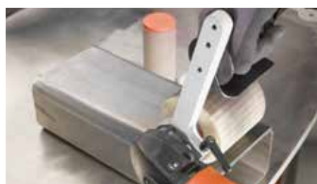
Nach dem Aufbringen der Vorpolierpaste die Oberfläche auf Spiegelglanz bringen
