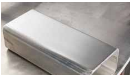
Superficie lijada hasta K1400, deben eliminarse todas las rayaduras
