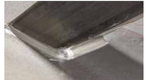
Superficie igualada y eliminación perfecta de colores de revenido en cordones
