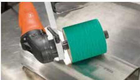
Eliminación de la película laminar y de rayaduras en la superficie
