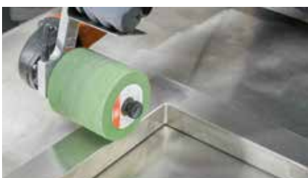
Acabado satinado sin adaptación de los ingletes
