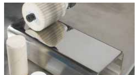
Tras el mecanizado con la pasta de abrillantado, brillo espejo óptimo en superficies de acero inoxidable
