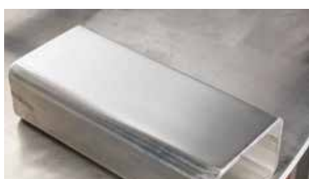
Ytan förslipad upp till K1400, alla repor måste vara åtgärdade
