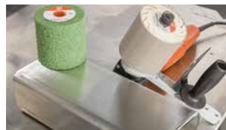
Fortsatt bearbetning av ytan med K400, K800 och K1400 förberedelse för polering
