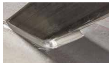
Utmärkt yta och pålitlig borttagning av anlöpningsfärger vid källsvetsar
