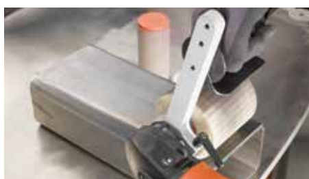
Po nanosení pasty na predbežné leštenie poskytnete zrkadlový lesk na povrchu
