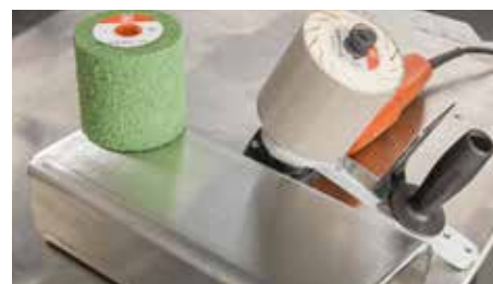
Ďalšie obrábanie plochy s K400, K800 a K1400 príprava na leštenie
