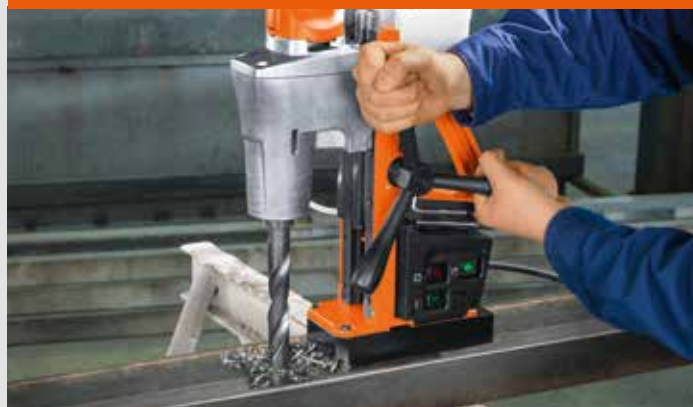
KBE 50-2 M / 65-2 M: so skľučovadlom alebo s upnutím nástrojov MK3
