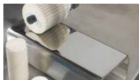
Po obrábaní s leštiacou pastou optimálny zrkadlový lesk na povrchoch z ušľachtilej ocele
