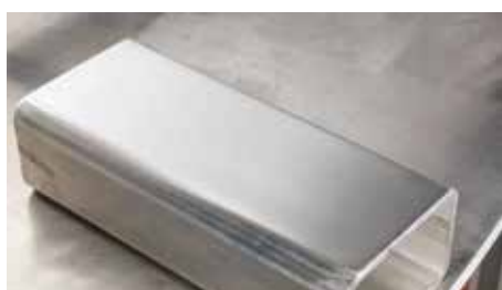
Predbrúsený povrch do K1400, všetky škrabance sa musia odstrániť
