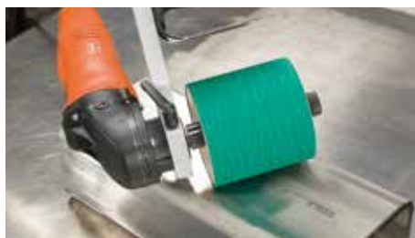
Odstraňovanie povlaku po valcovaní a škrabancov na povrchu
