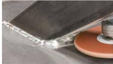
Verschleifen der Schweissnähte in schwer zugängigen Konstruktionen
