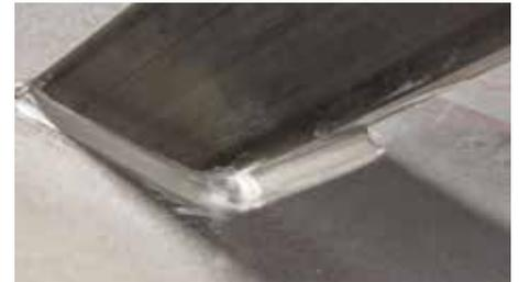
Angeglichene Oberfläche und zuverlässige Entfernung von Anlauffarben bei Kehlnähten
