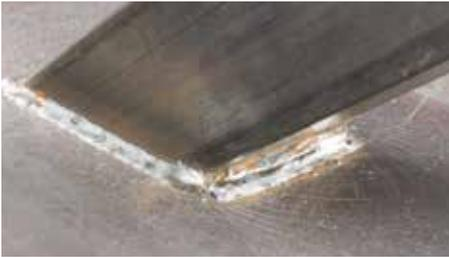
Unbearbeitete Schweissnähte mit Anlauffarben in Metallkonstruktionen
