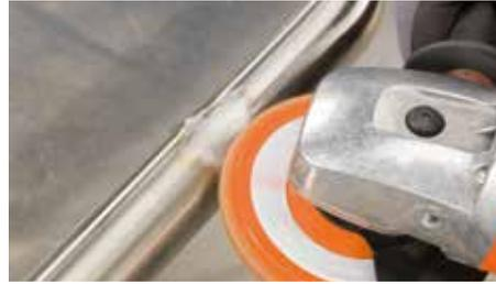
Abtrag der Schweissnaht ohne Beschädigung der angrenzenden Oberfläche
