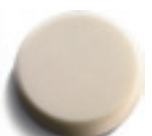
Spugna di lucidatura Per la lucidatura di superfici verniciate. Diversi gradi di durezza: morbida per vernici nuove, media per danni lievi da intemperie e applicazione di cera, DURA per vernici fortemente danneggiate dalle intemperie. Fissaggio rapido a velcro, altezza 40 mm.
