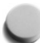
Polijstpons Voor het polijsten van gelakte oppervlakken. Verschillende hardheidsgraden: zacht voor nieuwe lak, medium voor lichte verwerking en aanbrengen van was, hard voor sterk verweerde lak. Klitbevestiging, hoogte 40 mm.
