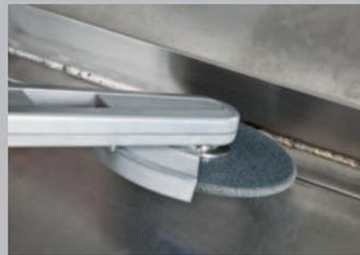
Poncez les soudures d'angle avec le disque fibre moyen pour obtenir le profil souhaité. Avec la pierre à profiler donnez aux disques fibres la forme souhaitée.
