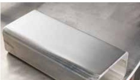
Surface préparée jusqu'au Grain 1400
