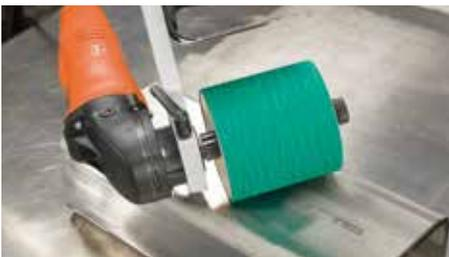
Élimination de la calamine et des rayures sur des surfaces (dégrossissage).
