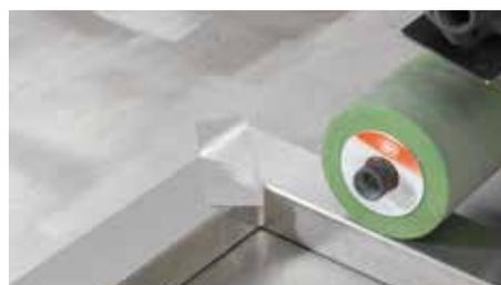
Recouvrement de l'onglet avec la bande inox
