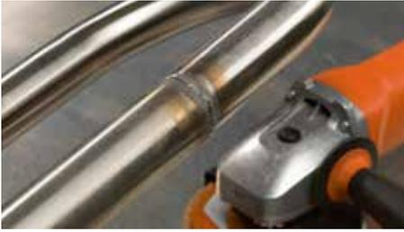
Cordon de soudure sur les profilés ou les arêtes.
