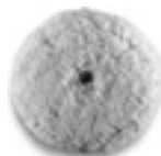
Круг Из Овчины Диаметр прибл. 230 мм для тарельчатых шлифовальных кругов Ø 170 мм, 6 38 06 187 01 0 М 14, с креплением-липучкой. Рекомендуемая рабочая частота вращения: 500–1 200 об/мин. Материал: TOPWOOL, полировальный диск типа „фризби“. Смесь овечьей шерсти и синтетики, моющийся.
