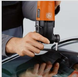
Los parabrisas herméticos y bastidores vulcanizados, incluso con refuerzo de aluminio, pueden extraerse en un paso de trabajo con la cuchilla L. Velocidad recomendada: nivel 3-4.
