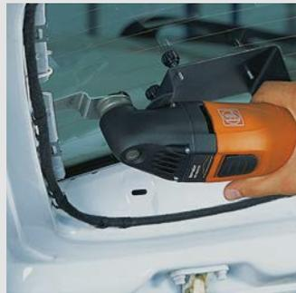
En algunos modelos VAG, las lunas traseras o cristales laterales están equipados con bastidor vulcanizado. FEIN le ofrece la solución perfecta para desmontar sin dañar los cristales de los modelos VW Passat Variant hasta 2004, del VW Polo hasta 01, Lupo, Seat y VW Golf III.
