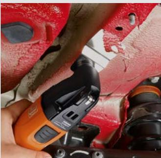
Con la espátula podrá eliminar la capa inferior de protección de suelos y la capa de protección contra piedras de forma fácil y rápida. De este modo, pueden dejarse al descubierto sin problemas puntos de reparación y p. ej. atornillar acoplamiento de remolque directamente en el bastidor. Velocidad recomendada: nivel 2-4.
