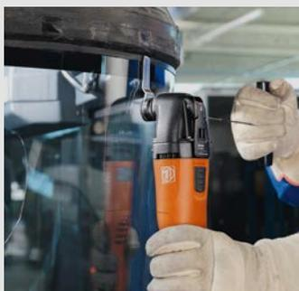
Para adhesiones de difícil acceso, como debajo de parasoles o en tableros de mandos de autobuses que no se pueden desmontar, es ideal la cuchilla reforzada forma 217. Velocidad recomendada: nivel 4–5.
