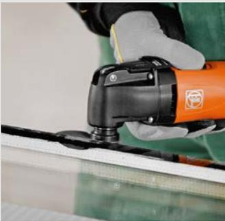
La cuchilla fungiforme separa lunas de vidrio aislante de autobuses y ferrocarriles de forma cómoda y rápida. Asimismo, pueden eliminarse muy fácilmente los restos de adhesivos del cristal.
