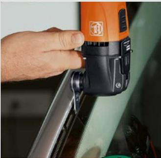
Con la cuchilla L tendrá con la misma velocidad una potencia de corte un 40% más elevada que con una cuchilla U similar. Los daños en la carrocería quedan prácticamente excluidos. Velocidad recomendada: nivel 3-4.
