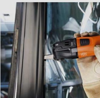
Los cristales adheridos en etapas o perfiles U pueden separarse con la cuchilla forma 177 con un corte angular de 8mm incluso en los cantos. Ideal para ventanas de autobús y ferrocarriles.
