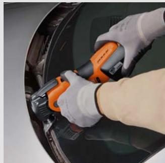
Para cortes en la parte inferior del parabrisas se utilizan las cuchillas U reforzadas. Velocidad recomendada: nivel 3–4.
