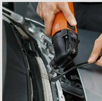
Con el raspador podrá eliminar restos de adhesivo de forma limpia, rápida y sin esfuerzo. Velocidad recomendada: nivel 2-3.
