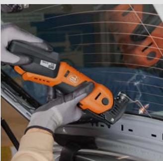
La cuchilla con la forma 143 está equipada con un rodillo de tope ajustable. De este modo, los cristales pueden separarse desde el interior de forma rápida y segura. Velocidad recomendada: máx. nivel 3.
