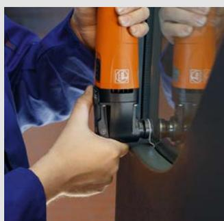
La cuchilla curvada forma 072 resulta muy adecuada para llevar a cabo cortes de separación desde el interior en cristales laterales. Velocidad recomendada: nivel 3–4.
