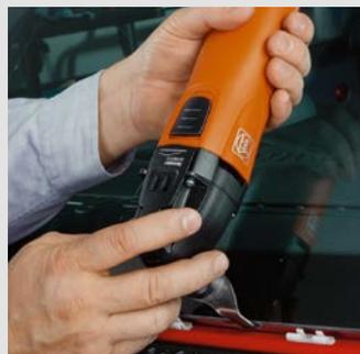
Para los cortes en la parte inferior del parabrisas se utilizan las cuchillas U. Velocidad recomendada: nivel 3-5
