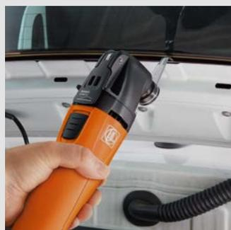
Los cristales laterales y lunas traseras herméticos pueden desmontar desde el interior con las cuchillas L en tres longitudes distintas hasta 38 mm.
