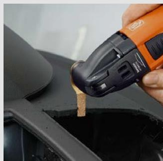
Para procesar posteriormente los cortes en lugares de difícil acceso, resulta ideal la lima revestida de metal duro: con ella podrá procesar sin esfuerzo plásticos, material compuesto y madera.
