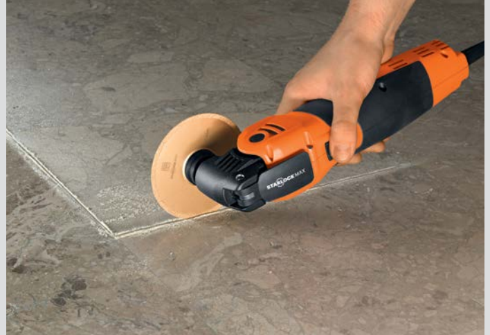
El disco de sierra de metal duro de tan solo 1,2 mm de ancho para juntas muy estrechas.
