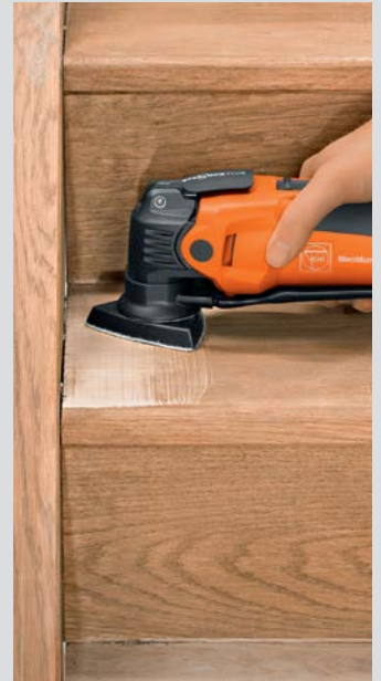
Desbaste en esquinas y bordes sin efectos de rebote.
