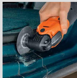
Serrado sin deformación, cantos de corte más limpios, línea de corte fina: ventajoso para trabajos en carrocerías.
