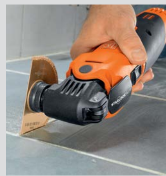
Con las hojas de sierra de 1,2 mm de ancho también pueden separarse juntas muy estrechas.
