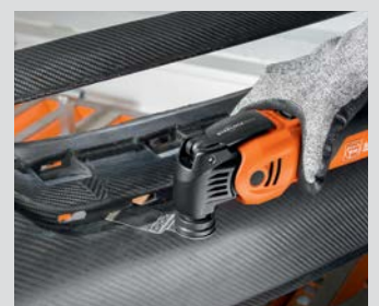
Eliminación de polvo perfecta con el dispositivo de aspiración.
