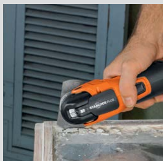
Sin riesgo de rotura del cristal gracias al movimiento de oscilación.
