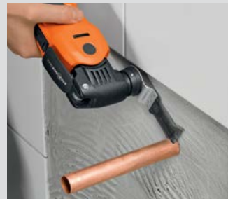
Serrar a ras de la pared en el mínimo espacio.
