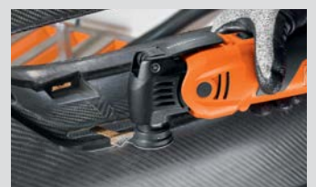
Desbarbado de componentes de plástico reforzado con fibra de carbono.
