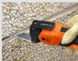
Lång skärkniv för mycket djupa fogar.
