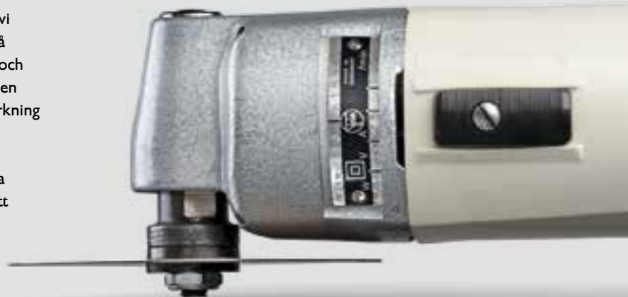
Det första originalet: FEIN såg med oscillerande sågblad från 1967.
