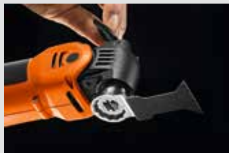
För att lossa, öppna spännpaken ...
