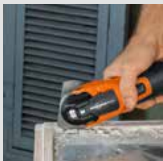
Ingen risk att glaset går sönder tack vare den oscillerande rörelsen.
