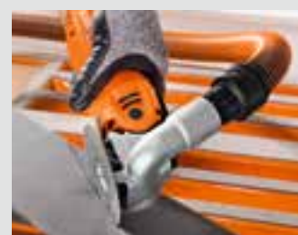
Perfekt dammuppsamling med utsugningsanordningen.
