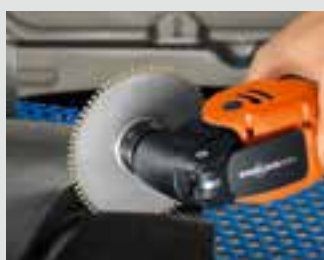
Raka snitt som ger mycket lite damm.
