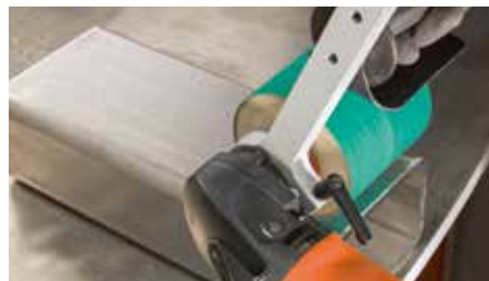
Ponçage et travaux de satinage.
