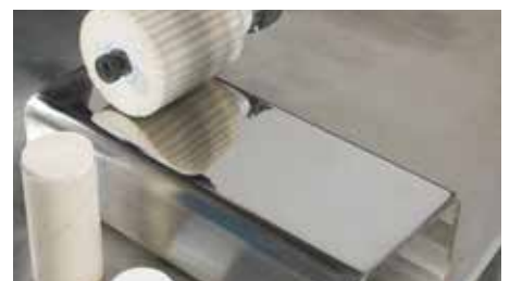
Polissage miroir avec la pâte de polissage.
