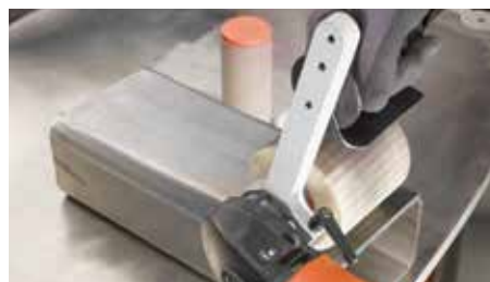
Prépolissage avec la pâte à prépolir.
