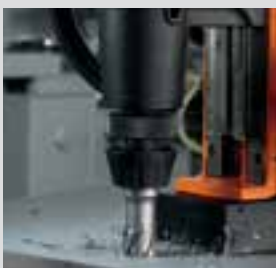
Perforación con corona
