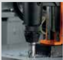
Perforación con corona
