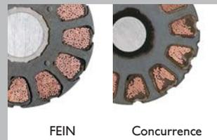
Forte densité de cuivre maximale pour un rendement supérieur et une résistance à la surcharge.
