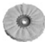
Rullo lamellare in feltro Per la lucidatura e la prelucidatura dell'acciaio inox. Grazie alle lamelle il feltro non «brucia» ed è possibile eseguire la lucidatura senza la formazione di strisce. Utilizzare solo con pasta di lucidatura (prelucidatura = crema di prelucidatura, lucidatura a specchio = crema di lucidatura).
