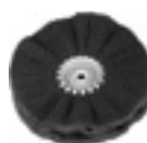
Anello in tessuto vlies ondulato ondulato, larghezza ca. 30 mm, foro 14 mm, per piccoli interventi di sbavatura, deossidazione, piccoli interventi di smerigliatura, decorazioni
