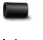
Verbindungsstück Universell einsetzbar zur Verbindung von Elektrowerkzeugen und Zubehören mit Staubabsaugung an Staubsauger. Flexible Gummihülse, Länge 70 mm, Innen-Ø 31,5 mm.
