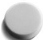
Polierschwamm Zum Polieren von lackierten Oberflächen. Unterschiedliche Härtegrade: weich für Neulacke, mittel für leichte Verwitterung und Wachsaufrag, hart für stark verwitterte Lacke. Klettenschnellbefestigung, Höhe 40 mm.
