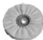
Filz Lamellenwalze Zum Polieren und Vorpulieren von Edelstahl. Durch die Lamellen „verbrennt“ der Filz nicht und es kann ohne Streifenbildung poliert werden. Nur mit Polierpaste verwenden (Vorpulieren = Vorpuliercreme, Hochglanzpolieren = Abglänzcreme).
