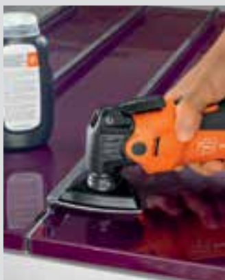
Polerowanie powierzchni na wysoki połysk.
