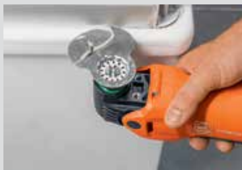
Usuwanie spoin łączących.
