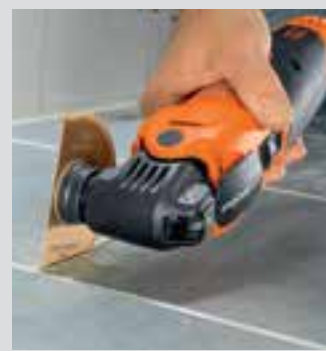
Brzeszczoty o szerokości zaledwie 1,2 mm umożliwiają wycinanie również bardzo wąskich spoin.
