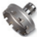
QuickIN PLUS -kiinnityksellä varustetut HM-reikäsahat Kovametallipaloin, ihanteellinen käyttöikä tehokkaisiin poraustöihin 4,0 mm:n materiaalihyvyyteen asti. Tuumamitat, leikkuusyvyys 4 mm/ 5/32".
