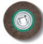
Teräsharja Ø 250 mm x 60 mm, erinomainen teräslangan lujuus erityisen taloudelliseen käyttöön, kiinnitysporaus Ø 51 mm. Teräslangan paksuus 0,2 mm ohutseinäisille putkille ja profiileille. Teräslangan paksuus 0,35 mm yleiskäyttöä varten. Teräslangan paksuus 0,5 mm paksuseinäisille putkille ja profiileille suurta jäysteenpoistotehoa varten. Jaloteräsmalli
