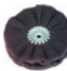
Hiomahuopa aaltolaskoksin, leveys noin 30 mm, reikä 14 mm, helppoihin jäyteenpoistotöihin, desoksidointiin, hiontatöihin, koristetöihin
