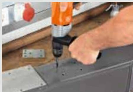
Los trabajos que requieren mucha potencia, como el roscado, pueden llevarse a cabo de forma fiable gracias al elevado nivel de par constante.
