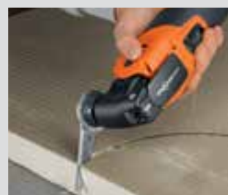
Tăierea la dimensiune a plăcilor de construcții.
