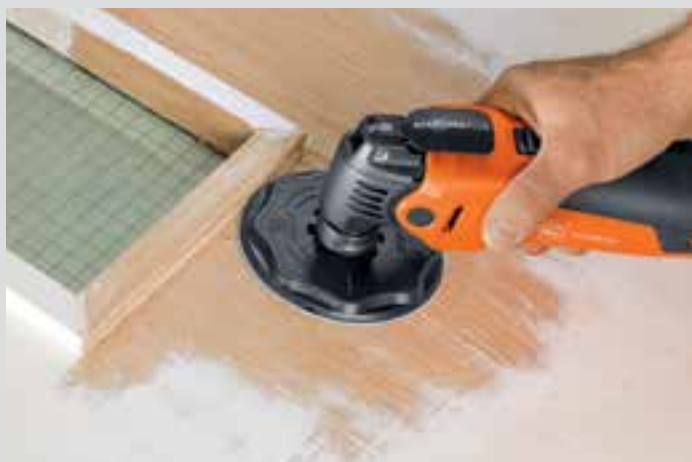
Suportul de șlefuit mare, rotund, înlocuiește mașinile de șlefuit suplimentare, precum șlefuitoarele excentrice sau oscilante.
