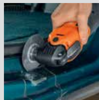
Tăiere fără sincope, muchii de tăiere curate, linii de tăiere subțiri - un avantaj la lucrările de caroserie.
