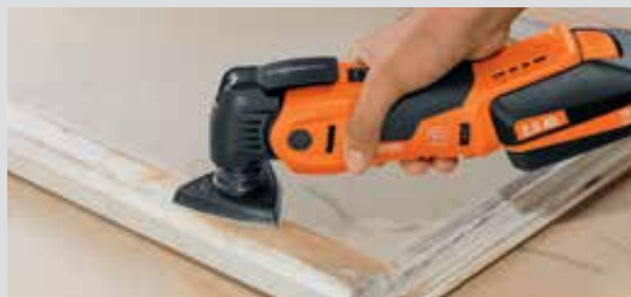
Șlefuirea la colțuri și canturi fără efecte de recul.
