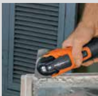
Datorită mișcării oscilatorii, eliminarea riscului de spargere a sticlei.
