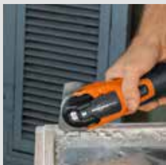
A rezgőmozgás nem okoz üvegtörést.
