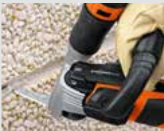
Veszélyes fugaanyagok (pl. PCB) megmunkálása során porelszívót kell használni.
