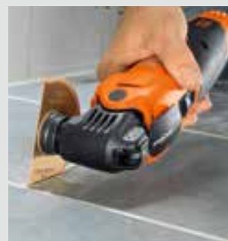
A csak 1,2 mm széles fűrészlapokkal a nagyon keskeny fugák is kivághatóak.
