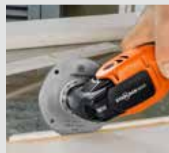
Szögek átvágása az üvegszegélyeknél.
