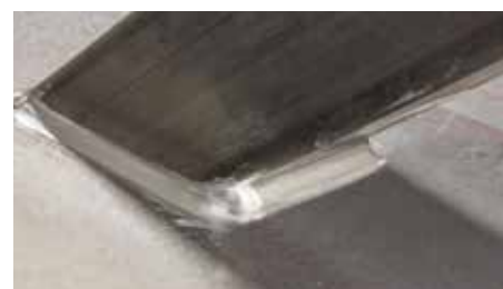
Vyrovnaný povrch a spolehlivé odstranění náběhových barev na koutových svarech
