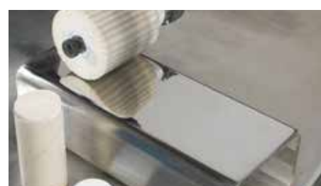
Po opracování se stahovací pastou optimální zrcadlový lesk na nerezových plochách
