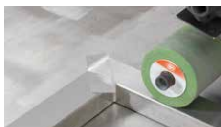
Zakrytí a vyrovnání zkoseného řezu při satinování
