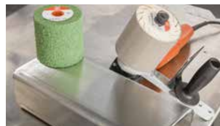
Další opracování povrchu s brusnými pouzdry K400, K800 a K1400, příprava na leštění
