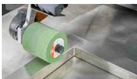
Satinovací finišování bez úpravy zkosených řezů
