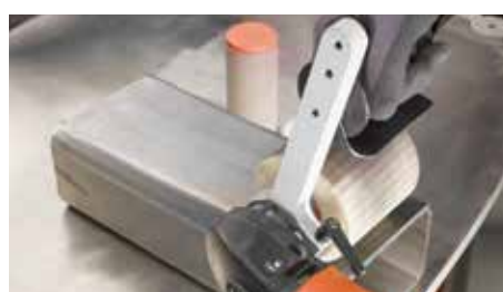
Po nanesení pasty na předleštění se povrch vyleští do zrcadlového lesku
