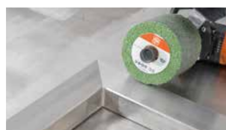
Čistý obraz broušení u zkoseného řezu až k okrajům
