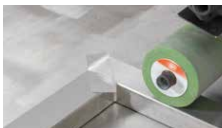
Afdækning og udjævning af geringen ved satinering
