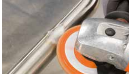
Afslibning af svejsesømmen uden beskadigelse af den tilstødende overflade
