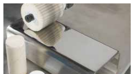
Efter bearbejdning med glanspasta optimal spejlgans på flader i rustfrit stål
