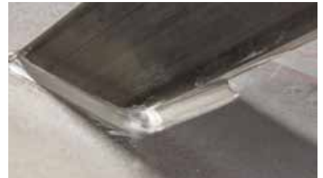
Udjævnet overflade og pålidelig fjernelse af anløbsfarver ved kantsømme
