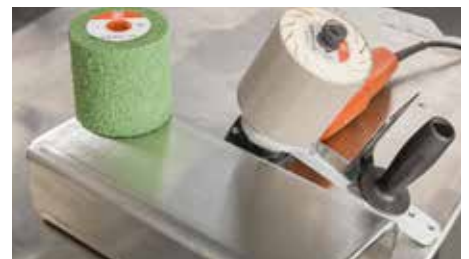
Yderligere bearbejdning af overfladen med K400, K800 og K1400 forberedelse til polering
