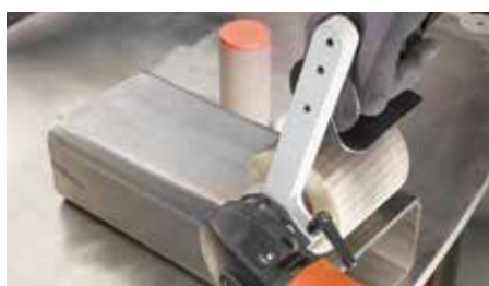
Efter påføring af forpolerpastaen poleres overfladen til spejlgans
