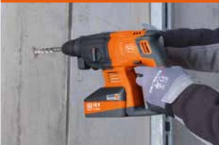
Hammerbohren in Beton bis 20 mm.
