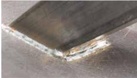
Unbearbeitete Schweißnähte mit Anlauffarben in Metallkonstruktionen
