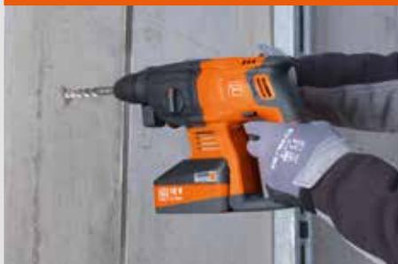
Perçage dans le béton jusqu'à 20 mm.
