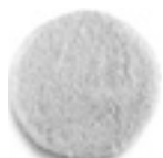
Fliesová podložka Kartáčovací rouno na čištění nebo polituru lodních trupů a palub Ø 195 mm na brusný talíř Ø 170 mm 6 38 06 187 01 0 M 14 s upínáním na suchý zip. Na sklolaminát protiskuzové struktury. Doporučené pracovní otáčky: cca 500 ot./min.
