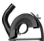
Ochranný kryt odsávání s vodícími saněmi pro rozbrušovací kotouče Ø 230 mm, řezná hloubka 65 mm, připojení Ø 32 mm
