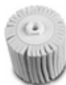
Plstěný lamelový válec K leštění a předběžnému leštění ušlechtilé oceli. Díky lamelám se plstě „nespálí“ a při leštění nevznikají žádné rušivé pruhy. Používejte pouze společně s leštící pastou (předběžné leštění = krém na předběžné leštění, leštění do vysokého lesku = stahovací krém).
