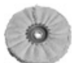
Leštící kotouč, sisal, sukno k jemnému broušení/kartáčování a zarovnáání neželezných kovů po předbroušení se zrnem 240-280 s brusnou pastou „žlutou“: - jemné broušení/kartáčování a zarovnáání litiny/oceli a ušlechtilé oceli po předbroušení se zrnem 280-320 se „žlutou“ brusnou pastou
