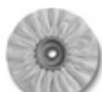
Leštící kotouč, sukno, měkké šířka ca. 15 mm, otvor 14 mm, k leštění neželezných kovů, litiny/oceli a ušlechtilé oceli a chromu stahovací pastou do vysokého lesku „bílá“
