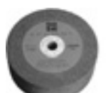
Leštící kotouč Ø 150 mm, šířka 60 mm, elastický, vrtání 14 mm k satinování, zrno 16 (hrubé), měkké, „zelený“
