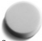
Polersvamp Til polering af lakerede overflader. Forskellige hårdhedsgrader: blød til ny lak, middel til let forvitring og voksning, hård til stærkt forvitret lak. Velcrolukning, højde 40 mm.
