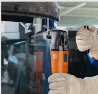
Le couteau renforcé de forme 217 est parfait pour les zones collées difficiles d'accès, par exemple, sous les pare-soleils ou les panneaux d'affichage non démontables d'autobus. Vitesse recommandée : position 4-5.
