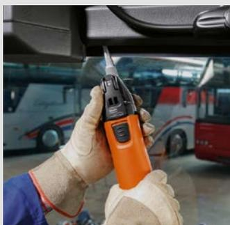
Le couteau de forme 081 peut être utilisé pour déposer les vitres de très grande taille de l'intérieur. Vitesse recommandée : position 3-5.
