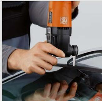
Les pare-brise et les cadres vulcanisés, même renforcés d'aluminium, peuvent être déposés en une seule étape avec le couteau en forme de L. Vitesse recommandée : position 3-4.
