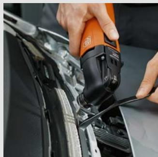
Le racloir est utilisé pour enlever aisément, proprement et rapidement les restes de colle. Vitesse recommandée : position 2-3.
