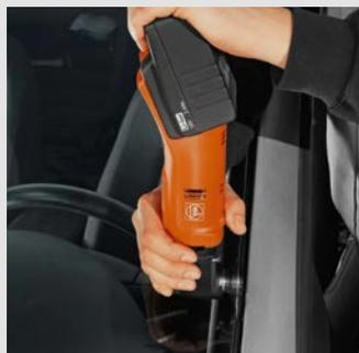
Coupe extrêmement rapide : le couteau en L forme 207 présente une puissance de coupe 40 % supérieure à vitesse égale par rapport à un couteau en U comparable. Un avantage de taille pour la dépose de pare-brise de l'extérieur. Vitesse recommandée : position 3-4.
