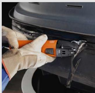
Utilisez le racloir pour enlever aisément, proprement et rapidement les restes de colle, même aux endroits difficiles d'accès.
