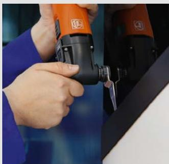
Démontez proprement et facilement le cadre enjoliveur collé, avec les couteaux droits de forme 081 et 216. Vous pouvez ainsi réutiliser le cadre dans la plupart des cas. Vitesse recommandée : position 3-5.
