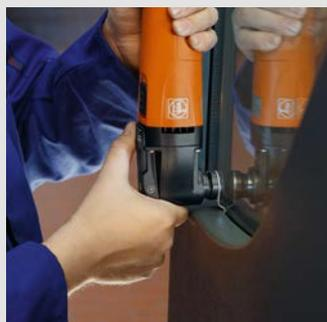
Le couteau incurvé de forme 072 est idéal pour démonter les vitres latérales de l'intérieur. Vitesse recommandée : position 3-4.
