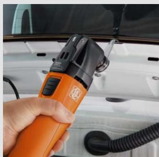
Les vitres latérales et arrière encapsulées peuvent être déposées de l'intérieur au moyen des couteaux en L disponibles en trois longueurs (jusqu'à 38 mm).
