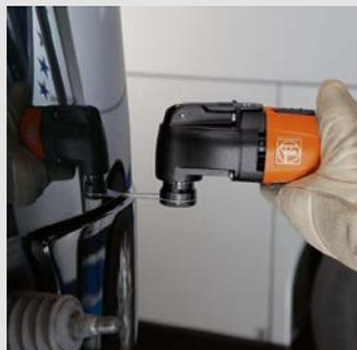
Les couteaux en L de formes 207 et 209 sont utilisés pour les vitres de camions et d'autobus à jeux de montage réduits entre la vitre et le cadre. Ils permettent également de tronçonner facilement et rapidement les barres fixes. Vitesse recommandée : position 4-5.
