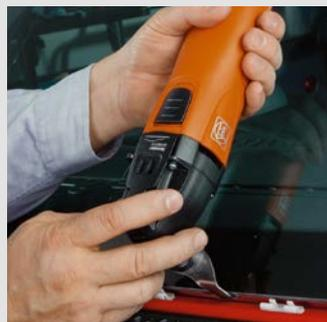
Les couteaux en U permettent la dépose de vitrages par-dessous le capot du moteur. Vitesse recommandée : position 3-5.
