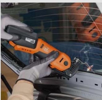
La lame de forme 143 est équipée d'un rouleau de butée réglable, ce qui permet de déposer rapidement et en toute sécurité le vitrage de l'intérieur. Vitesse recommandée : position 3 max.
