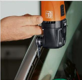
Le couteau en L présente une puissance de coupe 40 % supérieure, à vitesse égale, à celle d'un couteau en U comparable. Il minimise les risques d'endommagement de la carrosserie. Vitesse recommandée : position 3-4.
