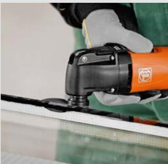
La lame forme champignon est utilisée pour la dépose facile et rapide des vitres isolantes d'autobus et de trains, ou pour enlever les restes de colle sur les vitres.
