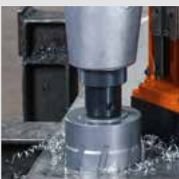
Perçage par carottage
