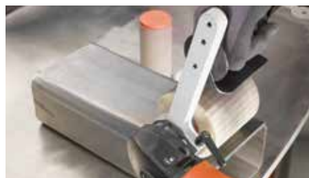
Na het aanbrengen van de voorpolijstpasta het oppervlak naar spiegelglans brengen
