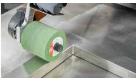
Satijnfinish zonder aanpassing van de verstekken
