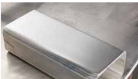
Oppervlak tot K1400 voorgeslepen, alle krassen moeten verwijderd zijn
