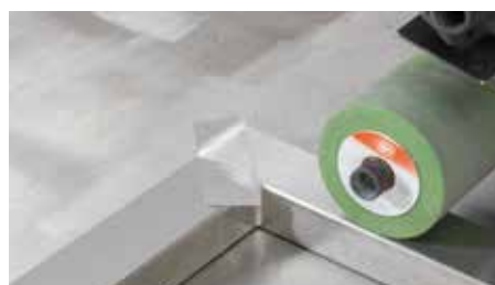
Afplakken en aanpassen van verstek bij het satineren
