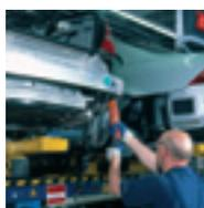
La construction coudée permet un vissage dans les endroits difficilement accessibles. L'orientation du renvoi d'angle peut, en outre, être modifiée de  $\pm 180$  degrés.
