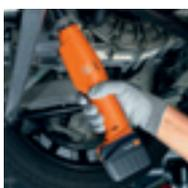
Grâce à la tension de la batterie plus élevée, les vitesses de rotation ont été ajustées à 600 tr/min. Pour un gain de temps lors du montage. La qualité de vissage exceptionnelle reste ainsi constante.
