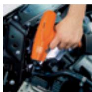
Les colliers de serrage et les vissages sensibles peuvent être vissés à l'aide de la visseuse à deux paliers tout en économisant du temps. La deuxième vitesse de rotation et le point de commutation sont réglés séparément, ce qui assure une résistance aux matériaux optimale.
