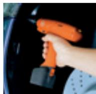
Les visseuses à poignée centrale sont équipées d'un mécanisme de démarrage progressif. En combinaison avec l'embrayage breveté, des tolérances de couple extraordinairement serrées sont atteintes.
