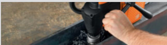
FEIN KBH 25 – La première unité de perçage manuel au monde, combine les avantages des perceuses portatives performantes et ceux des fraises au carbure. La nouvelle technique de perçage et la fraise au carbure HM spéciale permettent un travail polyvalent, confortable et rapide.
