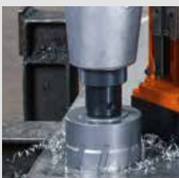
Perforación con corona
