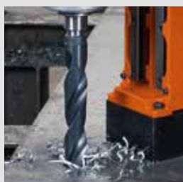
Perforación con broca espiral
