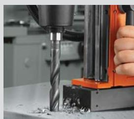
Perçage au forêt hélicoïdal avec mandrin
