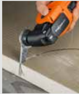
Découpe de panneaux de construction.
