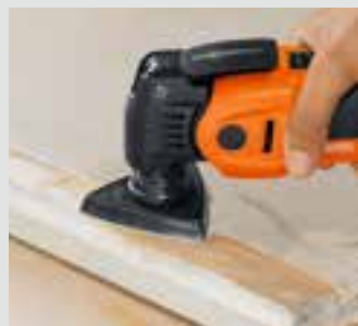
Ponçage dans les coins et sur les arêtes sans retour de choc.
