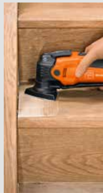
Brúsenie rohov a hrán bez spätných pohybov.
