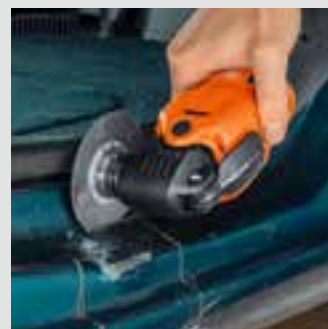
Pílenie bez deformácie, čisté hrany rezu, tenké línie rezu – výhoda pri prácach s karosériou.
