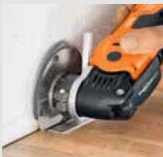
Bezproblémové dorezanie dilatčných škár.
