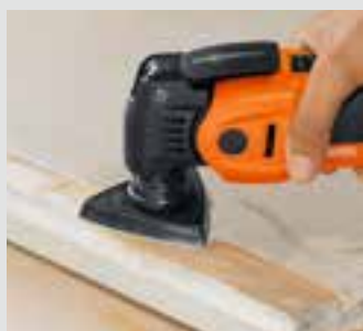
Brúsenie rohov a hrán bez spätných pohybov.
