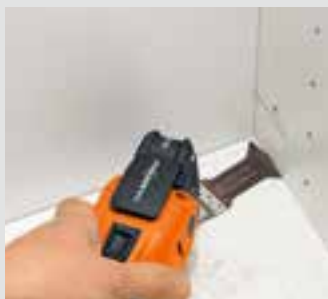
Škáry na nábytku na ťažko prístupných miestach.
