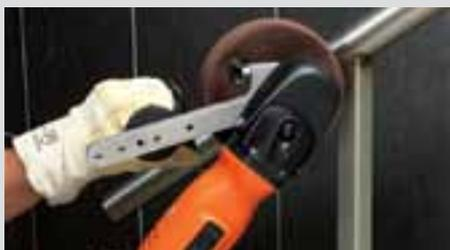
A polidora lixadora WPO 14-25 E: remoção eficaz de cores de têmpera. As telas com pregas flexíveis adaptam-se perfeitamente às formas da peça a trabalhar.
