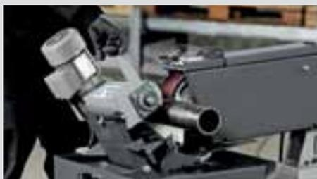
Módulo de retificação cilíndrica GRIT GIC: estrutura da superfície de polimento para a preparação do polimento de tubos.
