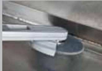
Os cordões de solda são lixados como o disco de lâ de cordeiro (médio) para o perfil desejado. A pedra de amolar volta a dar forma aos discos de lâ de cordeiro.
