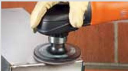
Remoção eficaz de cores de têmpera com a tela com pregas ou com o disco de lã. Para uma adaptação perfeita às costuras de solda.
