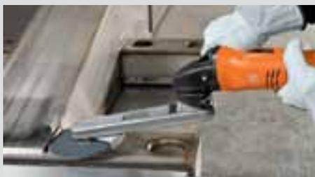
Trabalho eficiente desde o lixamento ao polimento espelhado com a lixadeira para cordões de solda.
