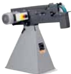
Lixadeira de cinta universal, com capacidade de ampliação modular, para aplicações profissionais em metal, ideal para o processamento de aço inoxidável na produção de baixo volume.
