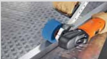
Para perfis em aço inoxidável e material plano: acabamento acetinado com as rodas de lã de cordeiro lamelares.
