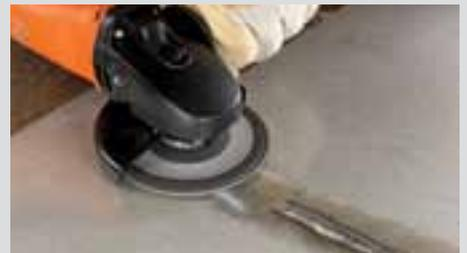
Mit hohem Drehmoment, aber drehzahlreduziert Schleifen mit Fächerscheiben. So wird hohe Hitzebildung am Werkstoff vermieden.
