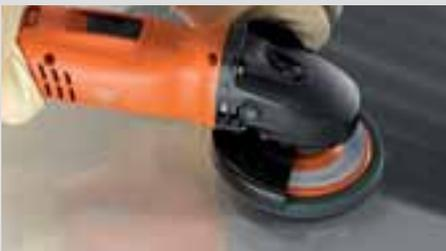
Lixamento pontual de riscos superficiais com um disco de acabamento. Para riscos mais profundos, discos abrasivos "Pyramix" autoaderentes.
