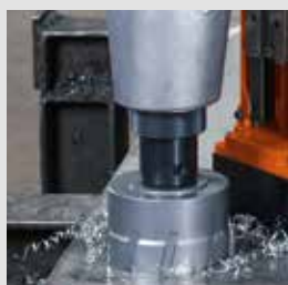
Perçage par carottage
