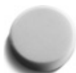
Leštiaca špongia Na leštenie lakovaných povrchov. Rôzne stupne tvrdosti: mäkký pre nové laky, stredný pre ľahko zvetrané laky a nanášanie vosku a tvrdý pre silno zvetrané laky. Rýchle upevňovanie na suchý zips, výška 40 mm.
