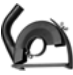
Ochranný kryt odsávania s vodiacími saňami pre rozbrusovacie kotúče Ø 180 mm, rezná hĺbka 40 mm, pripojenie Ø 32 mm
