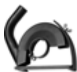
Capot de protection avec buse pour aspirateur pour disques à tronçonner Ø 180 mm, profondeur de coupe 40 mm, raccordement Ø 32 mm
