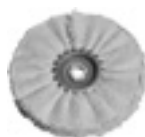
Roue à lamelles en feutre Pour le polissage et le prépolissage de l'acier inoxydable. Les lamelles empêchent que le feutre ne « brûle » et permettent ainsi un polissage sans formation de bandes. Utiliser uniquement avec de la pâte à polir (Prépolissage = Pâte de prépolissage, Polissage brillant = Pâte de polissage).
