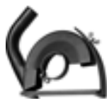
Capot de protection avec chariot de guidage pour disques à tronçonner Ø 230 mm, profondeur de coupe 65 mm, raccordement Ø 32 mm
