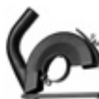
Capot de protection Avec buse d'aspiration, pour disques à tronçonner Ø 180 mm, profondeur de coupe 40 mm, raccordement Ø 32 mm.
